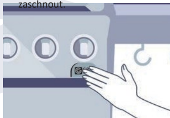
Obr. 7: Lepení magnetického adaptéru
